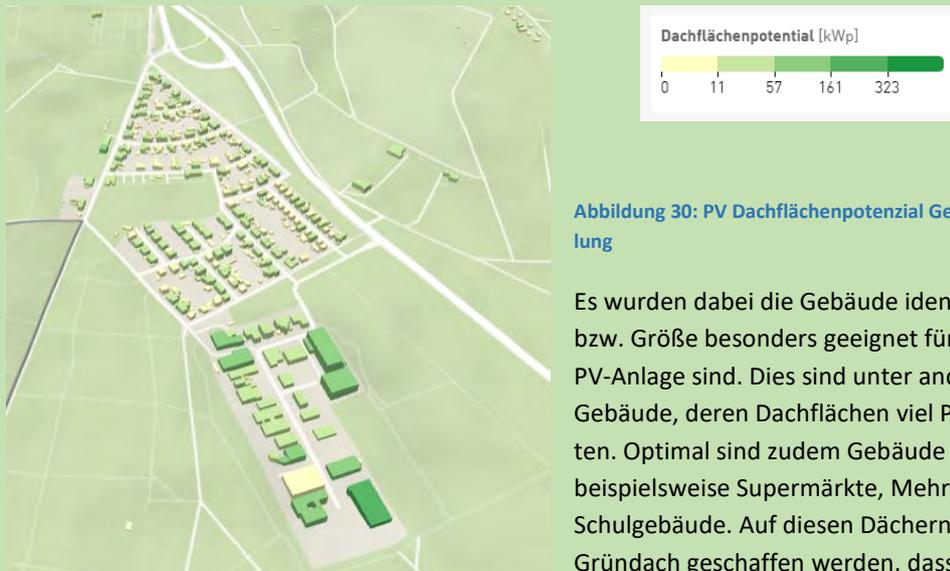
Abbildung 30: PV Dachflächenpotential Gebäude in der Hardtwaldsiedlung
